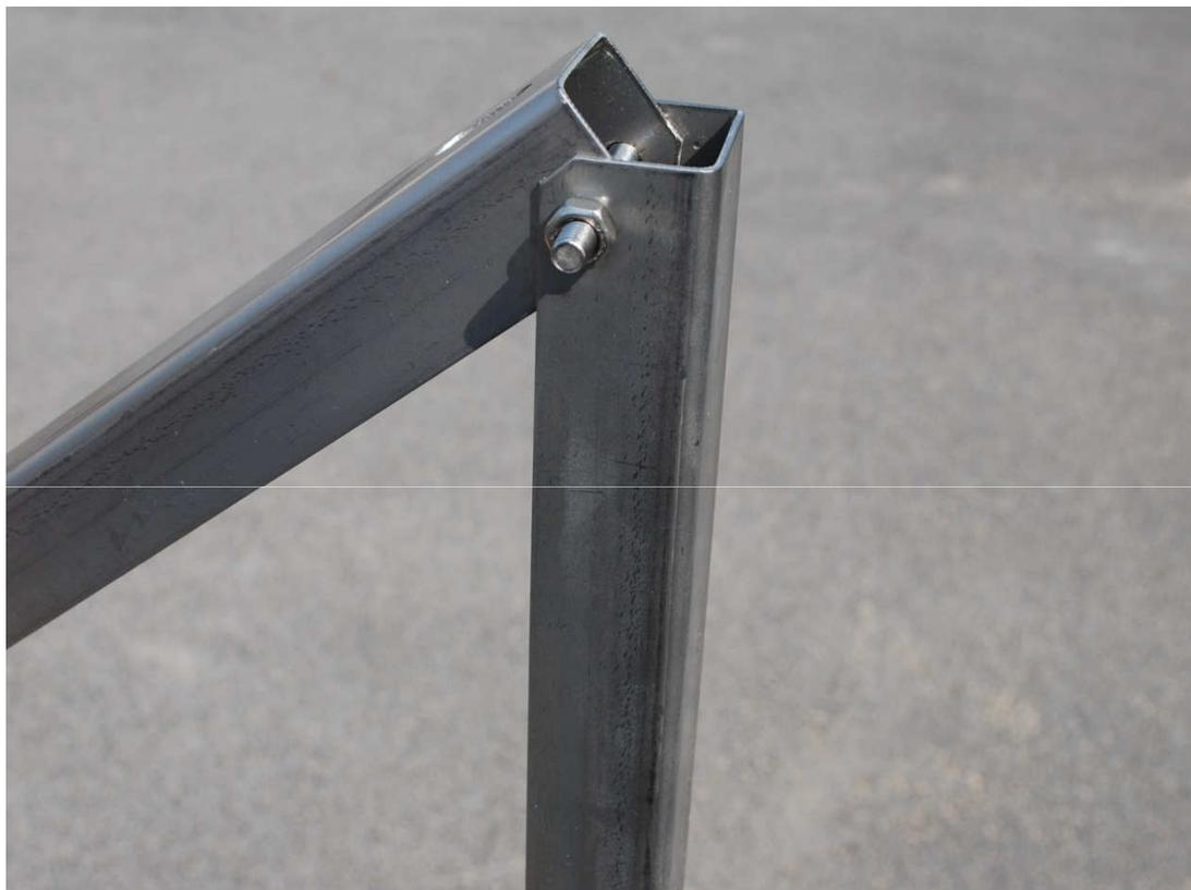
Etape 8 : Fixer les 2 supports (partie haute du capteur) avec une grande vis
