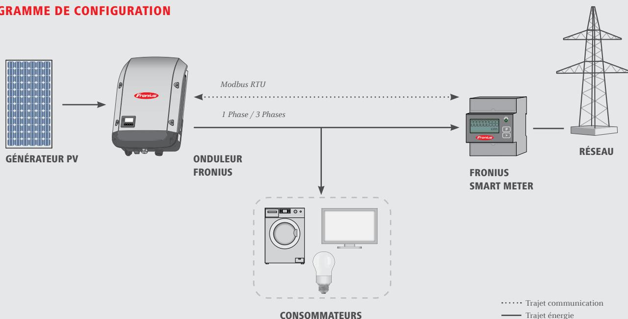
/ Le Fronius Smart Meter est compatible avec tous les onduleurs Fronius avec interface RS485 (Modbus RTU). Il fonctionne aussi avec la Datamanager 2.0 pour les Onduleurs Fronius IG Plus et avec la Fronius Datamanager Box 2.0 pour les onduleurs Fronius Agilo. Le Smart Meter et la Datamanager 2.0 peuvent être ajoutés ultérieurement à des onduleurs ayant déjà été installés.
