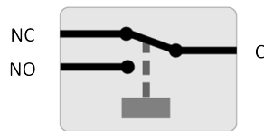
Configuration du relais (non alimenté)
