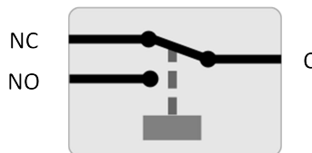
Fonctionnement interne du relais programmable
