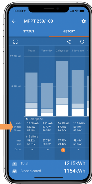
Historique de Pmax dans l'application VictronConnect.
