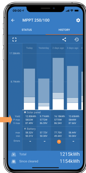
Historique de Pmax dans l'application VictronConnect.
