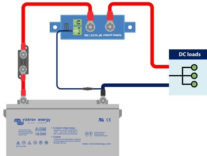
*BatteryProtect dans un système simple avec une boucle de fil entre les deux broches du connecteur de la borne distante (réglage d'usine)*
