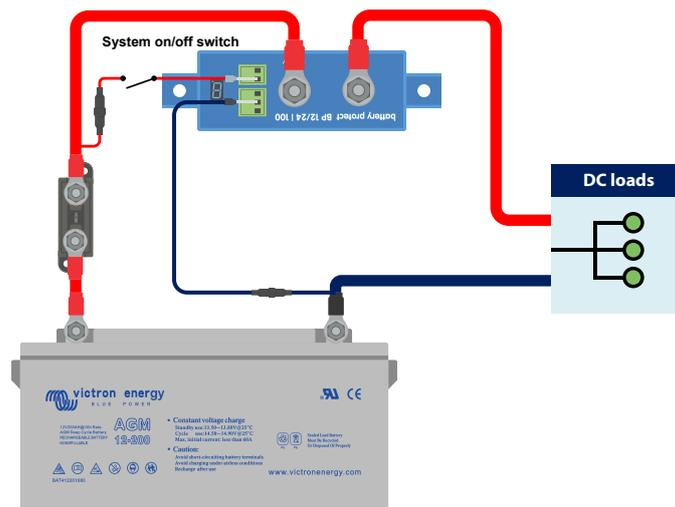
*Interrupteur câblé entre le positif de la batterie et la broche REMOTE de la borne distante*
