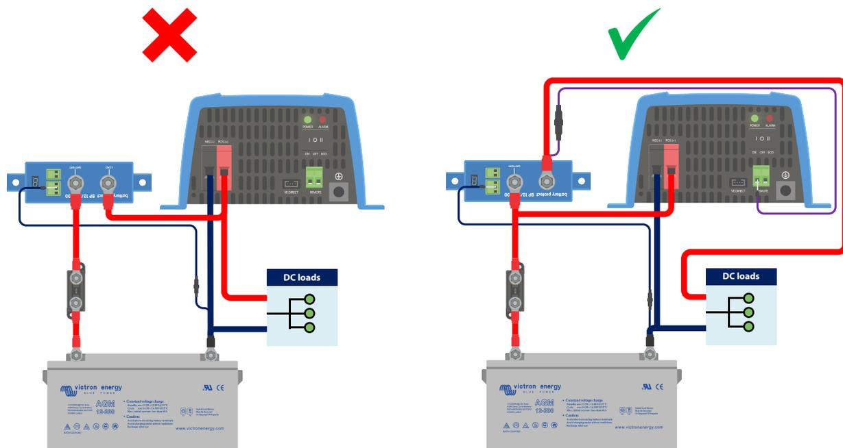
Image de gauche : Entrée CC d'un convertisseur connectée via un BatteryProtect - **strictement interdit**
