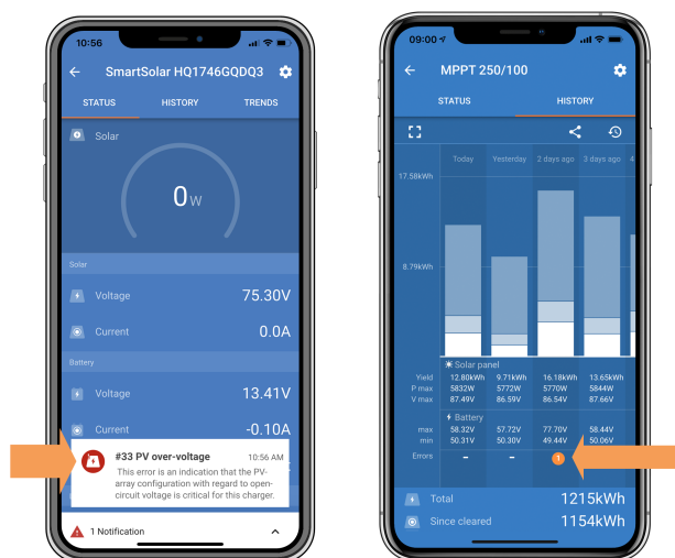
Application VictronConnect : capture d'écran d'une erreur #33 et capture d'écran de l'historique indiquant une erreur
