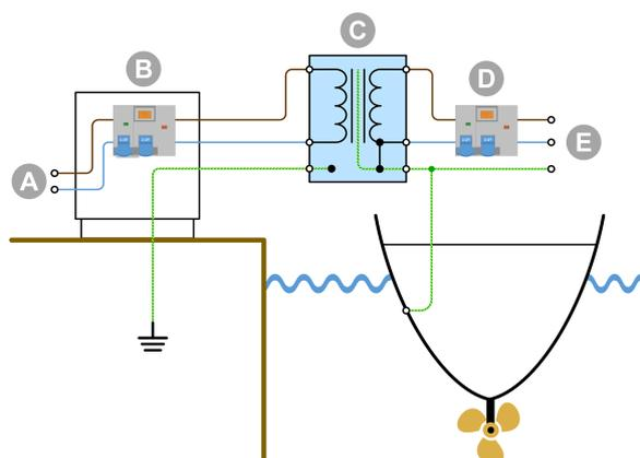
La terre du quai est isolée de la terre du navire et la corrosion galvanique issue de l'alimentation à quai est bloquée.
