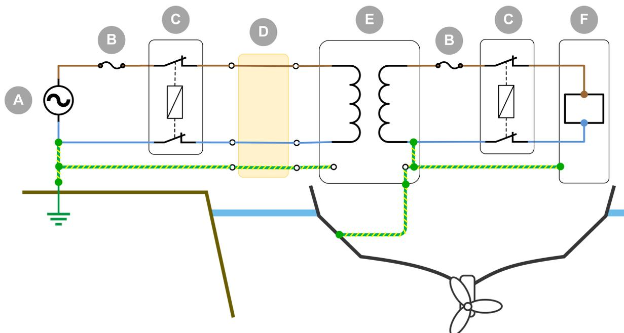
Exemple de câblage d'un transformateur d'isolement installé sur un navire raccordé à l'alimentation à quai.
