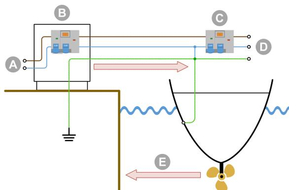
*Le fait de raccorder la prise de terre aux métaux immergés du navire entraîne une corrosion galvanique.*
